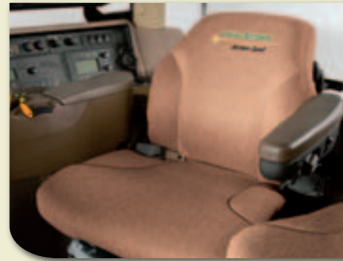
Die Federung des John Deere Active Seat bietet einen Fahrkomfort ohnegleichen. Hier wird ein Großteil der vertikalen Sitzbeschleunigungen neutralisiert. Erhältlich mit Stoff- und Lederbezug.
