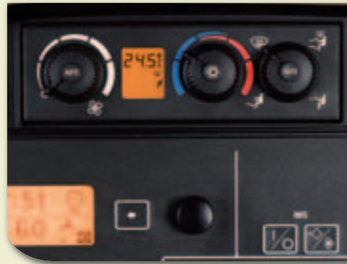
Bei der Klimaautomatik ClimaTrak (Wahlausrüstung) geben Sie Ihre Wunschtemperatur ein, die dann vom System geregelt wird. Bei Bedarf werden Luftverteilung und Gebläsedrehzahl automatisch eingestellt.
