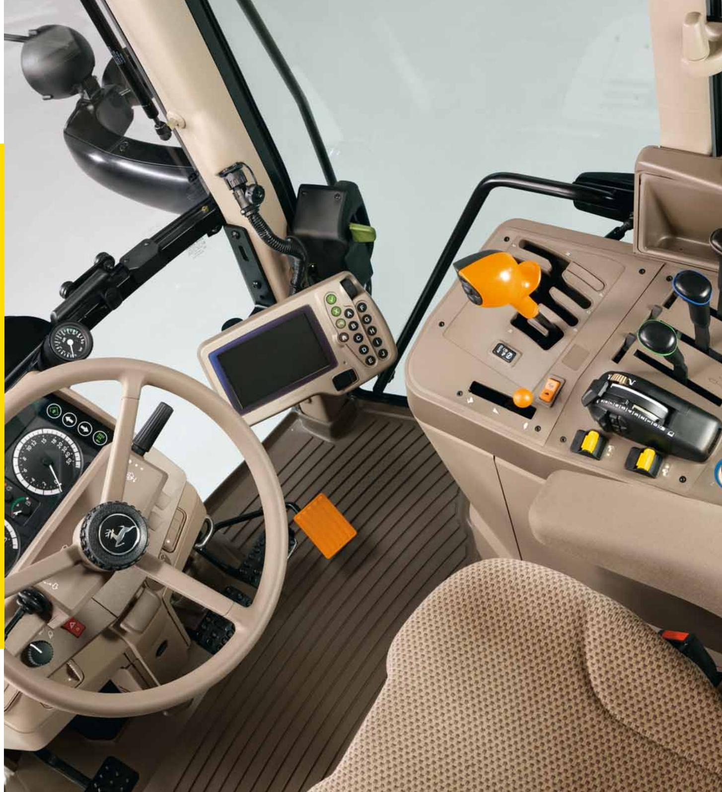
**StarFire**-Empfänger liefern satellitengestützte Informationen zur Positionierung in verschiedenen Genauigkeitsstufen. Der StarFire 300 empfängt das freie EGNOS-Signal, das eine Spurgenauigkeit von  $\pm 40$  cm ermöglicht und in Kombination mit der GreenStar Lightbar das ideale Einsteigersystem darstellt.
