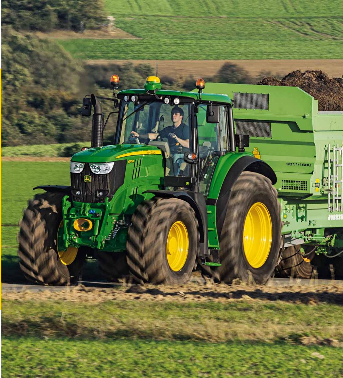
**PowrReverser\*** verfügt über jeweils 16 Vorwärts- und Rückwärtsgänge und einen elektrischen Reversierer für kupplungsfreie Richtungswechsel. Ideal für Ladearbeiten.
