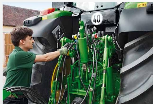
Mit einer Durchflussrate von bis zu 114 l/min passt die druck- und durchflusskompensierte Hochleistungshydraulik (PFC) den Durchfluss an den Bedarf an. So spart sie Kraftstoff und erhöht den Wirkungsgrad.
