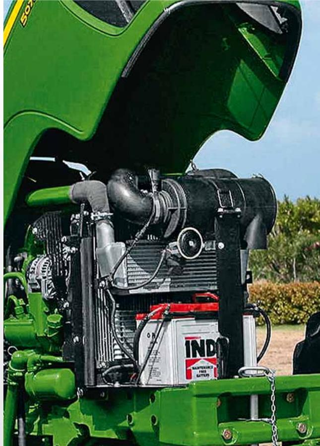
Der neue 2,9 Liter PowerTech M Motor mit Turbolader und Ladeluftkühler erfüllt die Abgasgrenzwerte der Stufe 3A.
